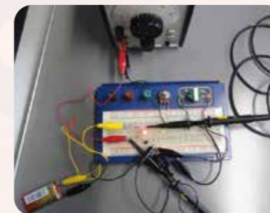
発光ダイオードの点滅速度を変えられる回路
